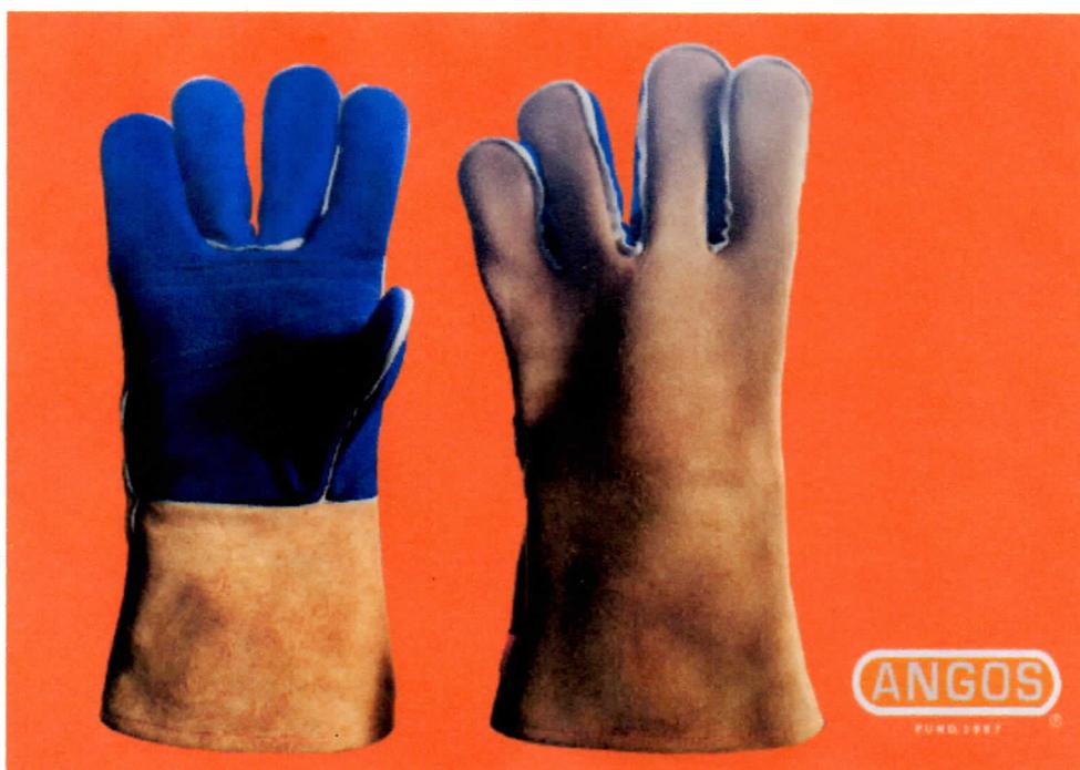
Elaborado en cuero semi gamuzón de 1.6 a 1.8 mm de espesor, flexible y resistente, costuras protegidas con refuerzos Y REFUERZO EN LA PALMA DE LA MANO, cosido con hilo Kevlar, forro interior con tela fleece, destinado para trabajos de soldadura eléctrica.
