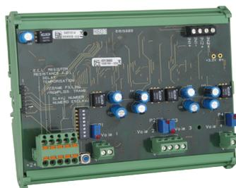
Módulo direccionable de 4 salidas analógicas que suministra 4 salidas de señales de 4 a 20mA analógicas (copia de salida del detector, mín., máx., promedio de un grupo de detectores) para la conexión con un registrador de datos, un controlador lógico programable (PLC), un Sistema de Administración de Edificio (Building Management System, BMS), etc.
