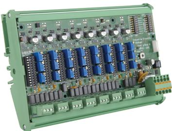
Este módulo admite la conexión de transmisores analógicos estándar (por ejemplo, detectores de gases o llamas) en una línea digital para el ahorro de costos.
