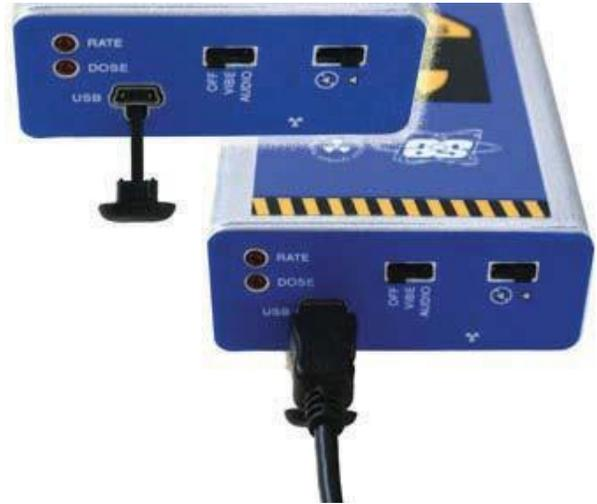
Fig. 2. Desconecte la cubierta del mini-USB del puerto USB y conecte el cable del mini-USB
